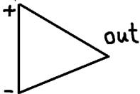
Я его называю «треугольник», хотя он на самом деле называется ОУ. Тут небольшая путаница в терминах — мы на базе треугольника ОУ будем конструировать также усилитель, но с гораздо меньшим коэфом усиления. Замечание: плюсом обозначают т.н. неинвентирующий конец треугольника, а минусом - инвентирующий конец. Это НЕ значит, что на плюсовой конец треугольника надо подавать положительный потенциал, а на минусовой отрицательный. Тут никакой связи нет.
