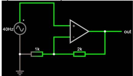
Будет положительная обратная связь. А так ничего особо не меняется, за исключением того, что ток теперь будет течь по другому ребру треугольника – с outa на +. Отношение напряжений выходного напряжения к входному будет при данном соотношении сопротивлений, как на рисунке, 3:1. Формула та же: K=1+R2/R1.
