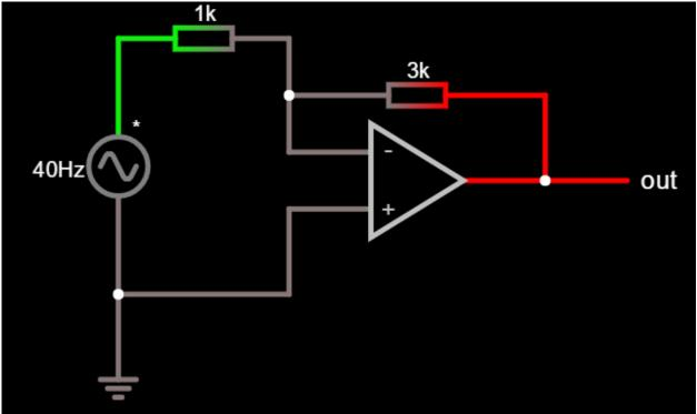
Слева стоит источник переменного тока на 40  $\Gamma$ ц, но на самом деле тут у нас стоит  $U_{\rm Bx}$ , которое мы будем усиливать. Это может быть как переменный синусоидальный ток, как и постоянный, так и переменный ток произвольной формы. Наш безынертный усилитель его усилит, сохранив форму.
